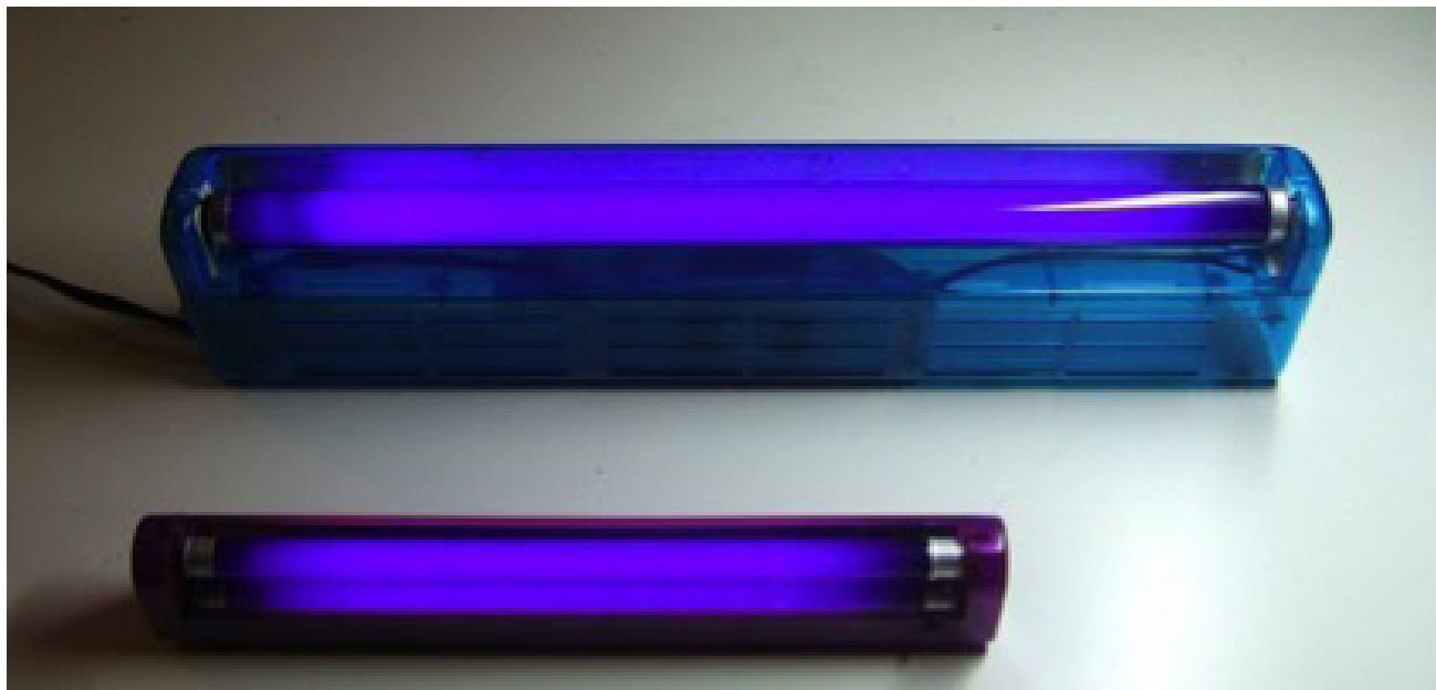
Figura 4. Lámparas de luz ultravioleta usadas principalmente como agentes germicidas. Las ventajas de eliminar microorganismos con este agente físico, es que no se dejan residuos químicos en los materiales irradiados.
